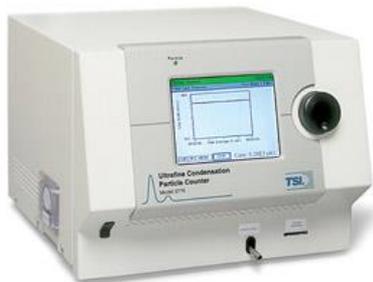
Sarà la prima stazione operativa in Italia a permettere la misura in maniera continuativa dei flussi di particolato atmosferico (con dimensioni fino a circa 2.5 nm) simultaneamente alle distribuzioni dimensionali per analizzare gli scambi atmosfera/superficie.
