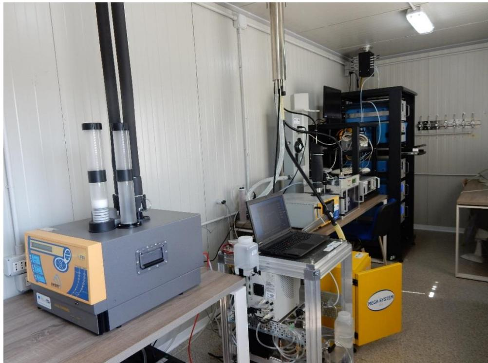
Un sistema spettrofotometrico DOAS passivo (GASCOD-NG4) realizzato opportunamente per la misura del contenuto colonnare a diversi azimut di  $\text{NO}_2$ ,  $\text{SO}_2$  ed  $\text{O}_3$ .
