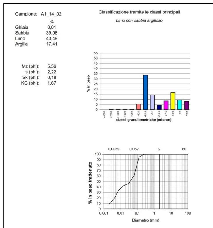
Figura 22 - Scheda granulometrica con rappresentazione grafica dell'analisi granulometrica e valori dei parametri statistici.
