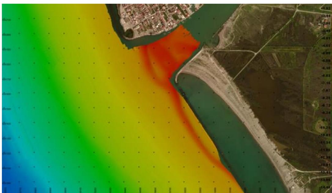
Figura 20 - Rilievo batimetrico della barra di foce.
