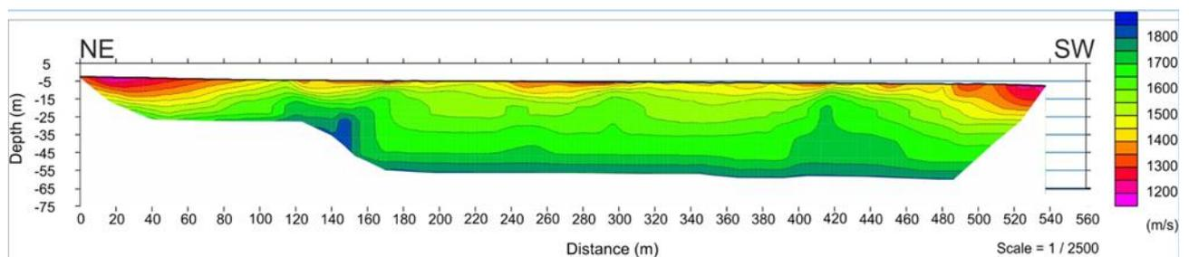
Figura 15 - Modello Tomografico della velocità delle onde P.
