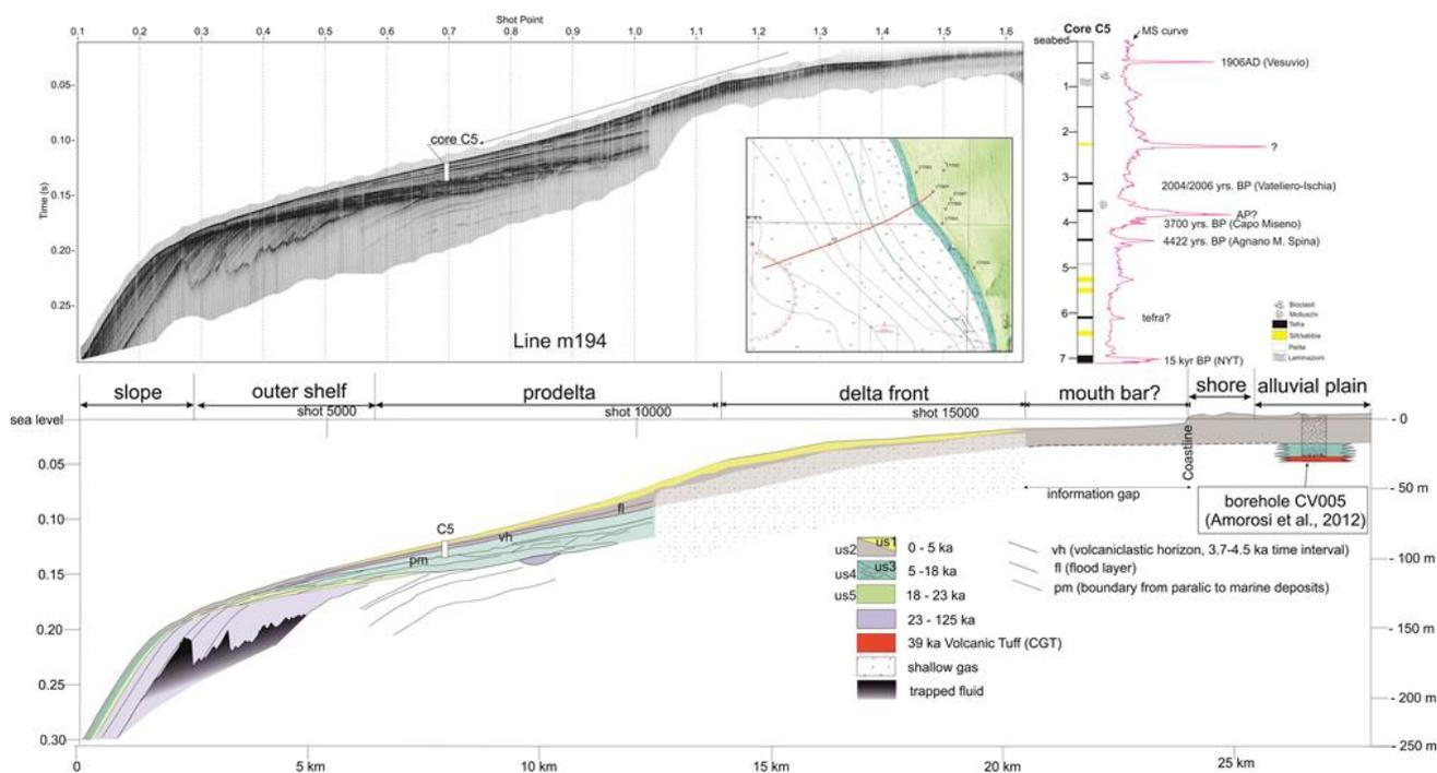
Figura 4 - Linea Subbottom Chirp m 194 (Fig. 1) con l'interpretazione delle unità e degli orizzonti significativi e sua calibrazione con il carotaggio a gravità C5; nella parte bassa una correlazione con la stratigrafia del sondaggio CV005 (Amorosi et al., 2012, Sacchi et al., 2014).
