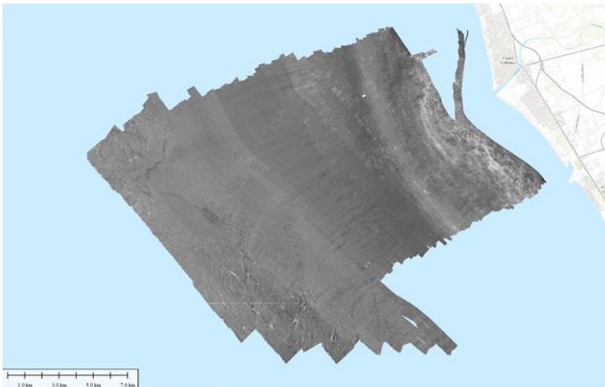
Figura 16 - Mosaico acustico dell'area acquisita alla foce del fiume Volturno ricavato con il processing dei dati di *backscatter* del Multibeam Simrad EM710.
