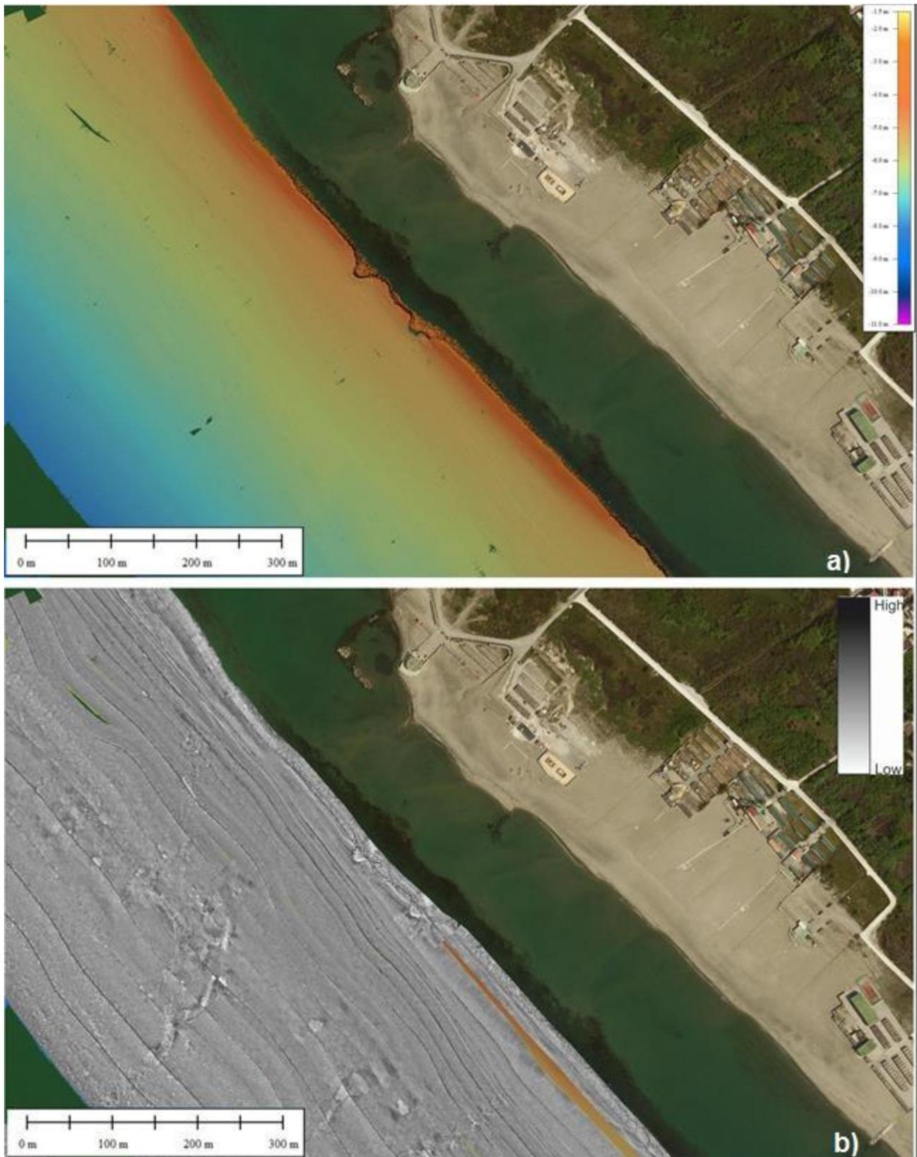
Figura 18 - Confronto tra il rilievo batimetrico (a) e il mosaico acustico (b) ottenuti con il Reson Seabat 7125 in una profondità compresa tra i -2 e -8m. Alcune facies acustiche, ben visibili nel *backscatter*, non corrispondono a variazioni morfologiche evidenti, ma sono caratteristiche di una variazione composizionale e litologica del fondo.
