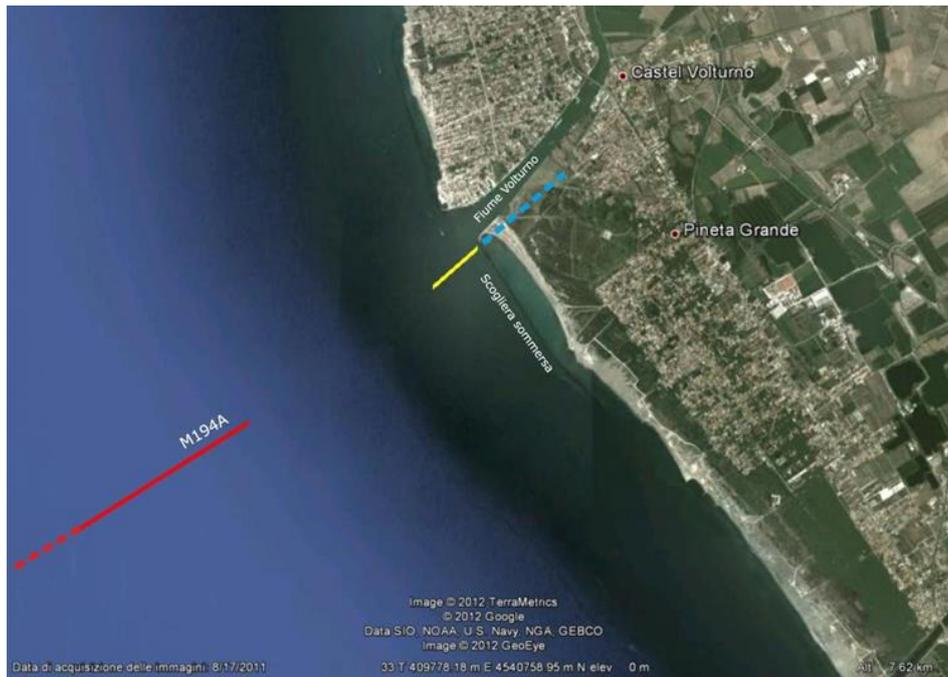
Figura 1 - Localizzazione (linea in giallo) del profilo sismico acquisito e del suo probabile prolungamento a terra (linea tratteggiata in blu). Viene, inoltre, raffigurata la linea sismica Chirp m194 (linea in rosso) acquisita nel corso della campagna GMS02\_01.
