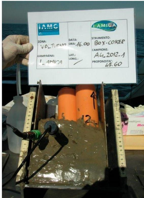
Figura 27 - Misurazione nel sedimento di T°, pH ed Eh e prelievo della carota di 20 cm per studi paleoambientali e paleoclimatici di alta risoluzione.
