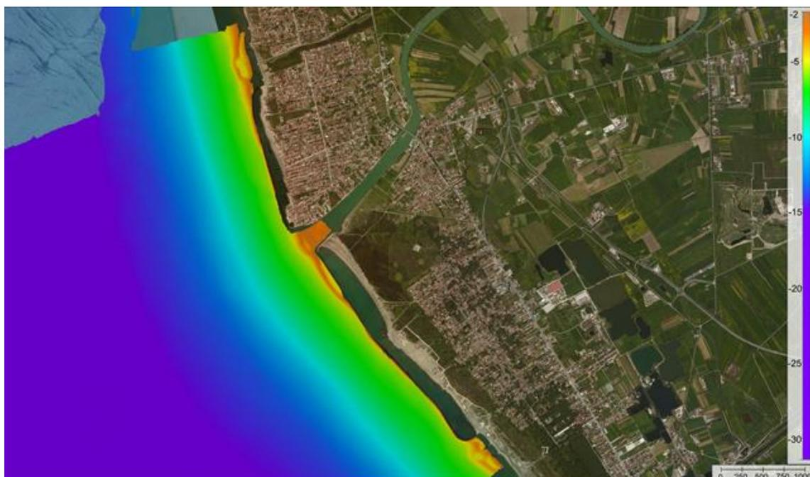
Figura 14 - Dettaglio del rilievo effettuato con SeaBat 7125.
