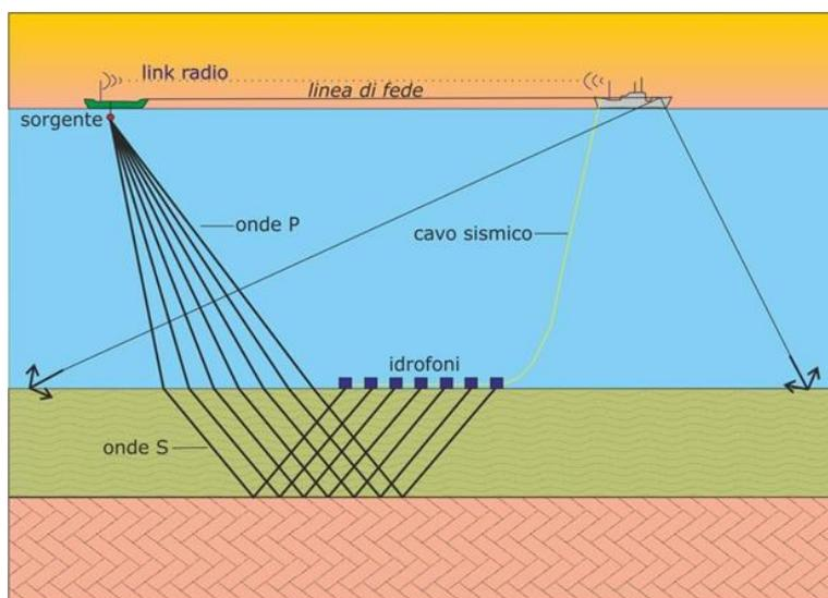
Figura 9 - Modello schematico della configurazione sorgente/ricevitori.
