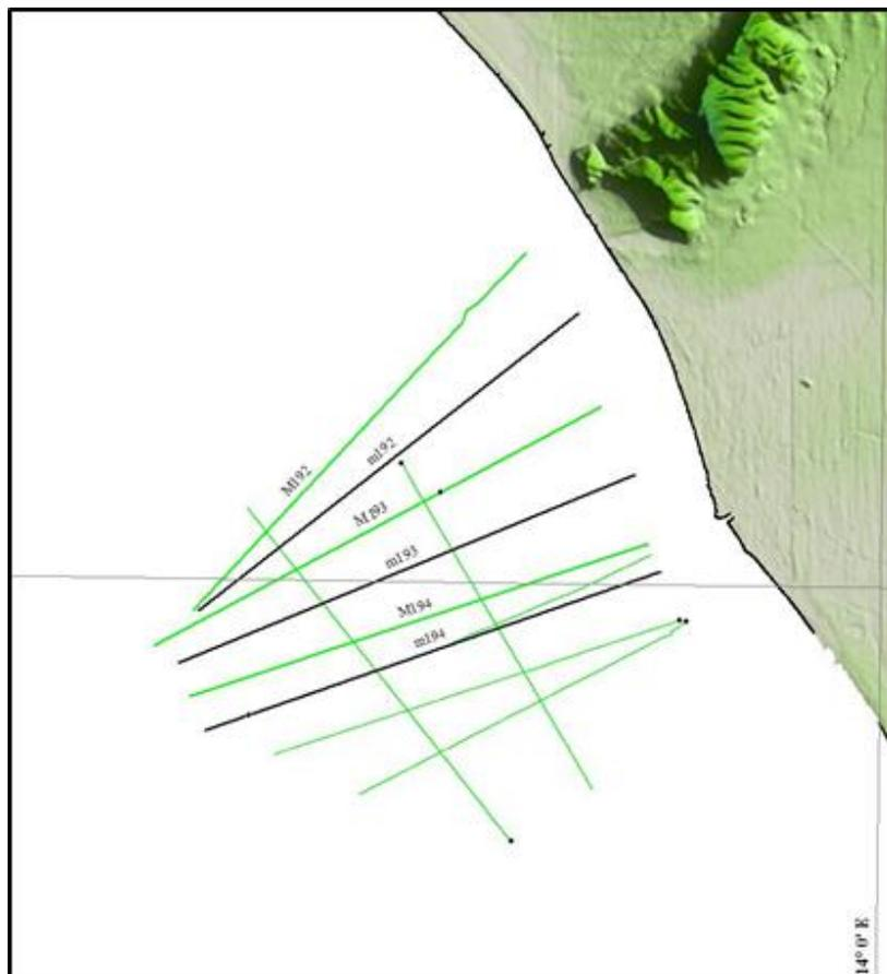
Figura 1 - Ubicazione delle linee sismiche Sparker (traccia in verde) e Subbottom (traccia in nero), utilizzate in questa relazione. La carota a gravità C5 è in rosso mentre il sondaggio CV005 in giallo (Amorosi et al., 2012; Sacchi et al., 2014)
