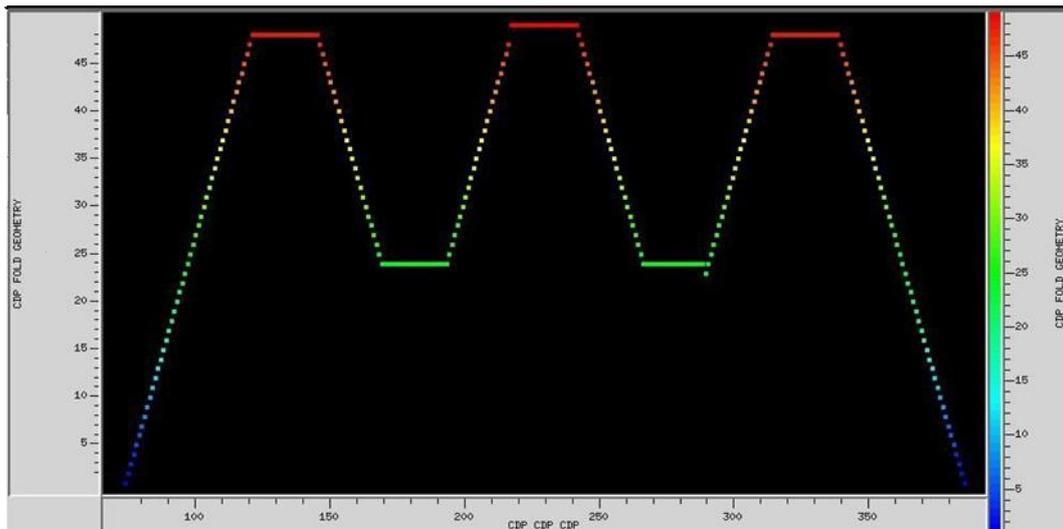
Figura 12 - Copertura dei CDP per il profilo sismico
