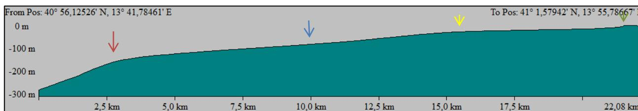
Figura 2 - Profilo topografico terra (dx) mare (sx) nel settore prospiciente la foce del Fiume Volturno. Le frecce indicano la rottura di pendenza tra margine di piattaforma e scarpata (rosso, -150 m), tra prodelta e piattaforma esterna (blu, -70 m), del fronte deltizio (giallo, -25 m) e della barra di foce? (verde, -12 m).
