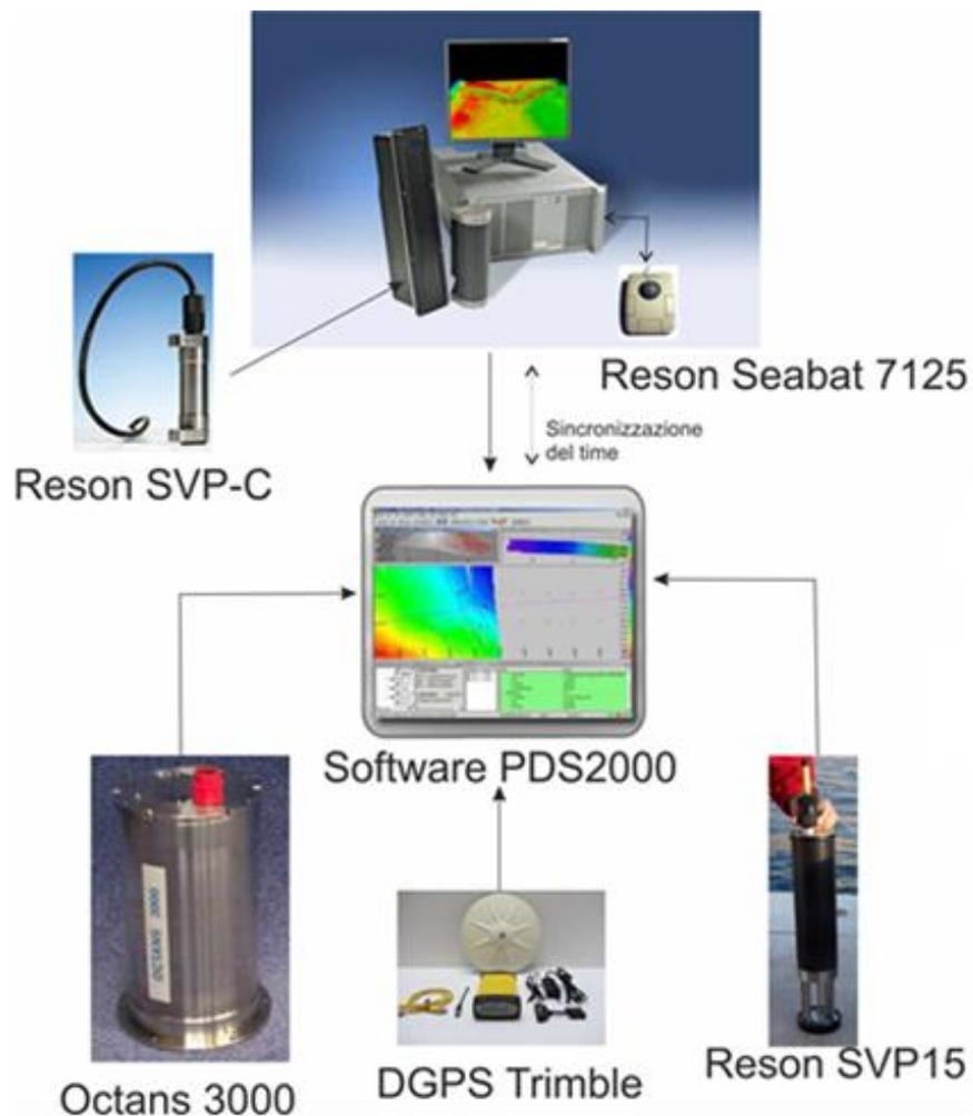
Figura 10 - Schema delle connessioni strumentali.
