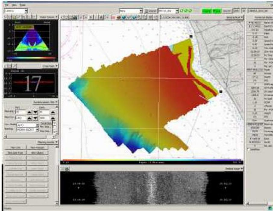
Figura 7 - DTM (Digital Terrain Model) acquisito nell'area di studio.
