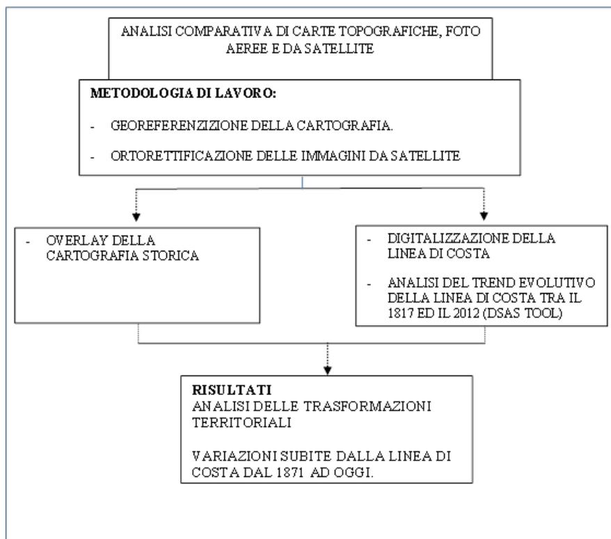
Figura 2 - Diagramma di flusso della metodologia utilizzata per lo studio delle variazioni della linea di costa della piana del fiume Volturno.
