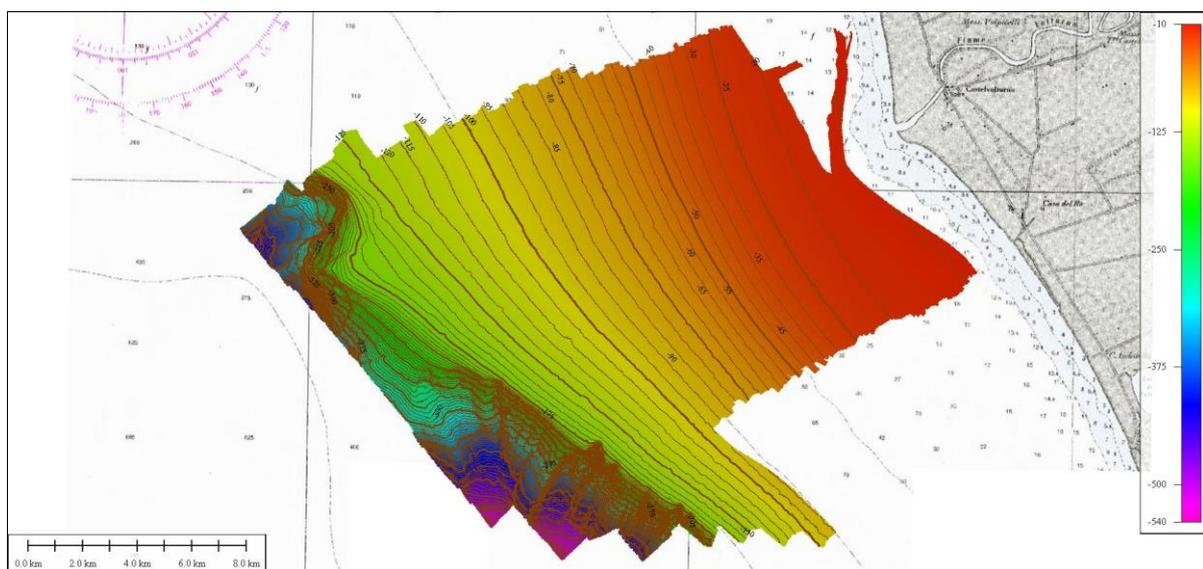
Figura 8 - DTM elaborato (risoluzione 5 m) dell'area di studio. Contouring batimetrico con intervallo di 5 m. Proiezione UTM33N – WGS84.
