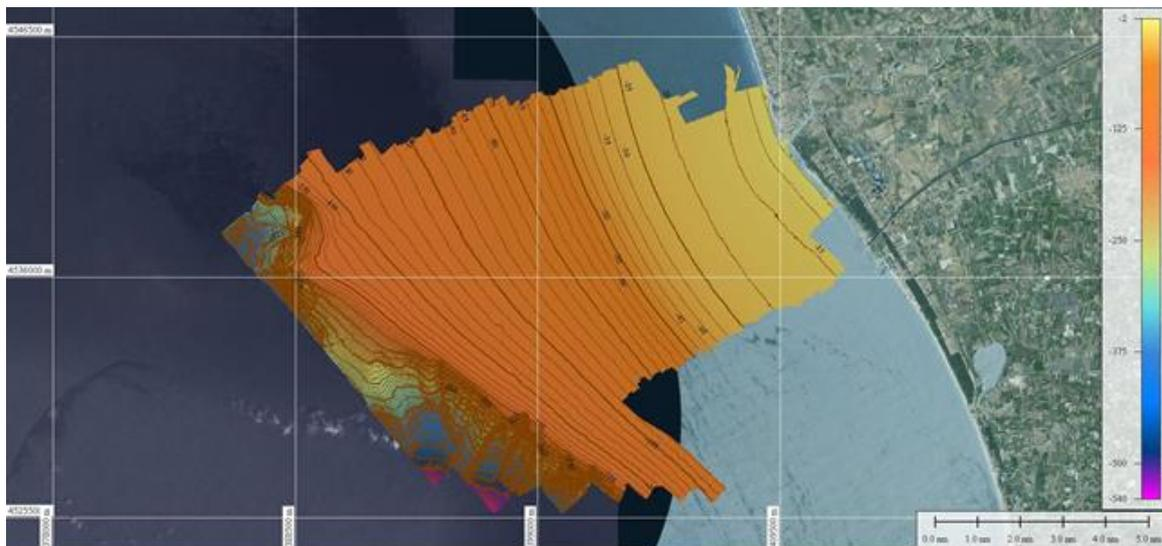
Figura 13 - Area totale acquisita derivante dalla integrazione dei dataset acquisiti con Multibeam EM710 e Seabat 7125.
